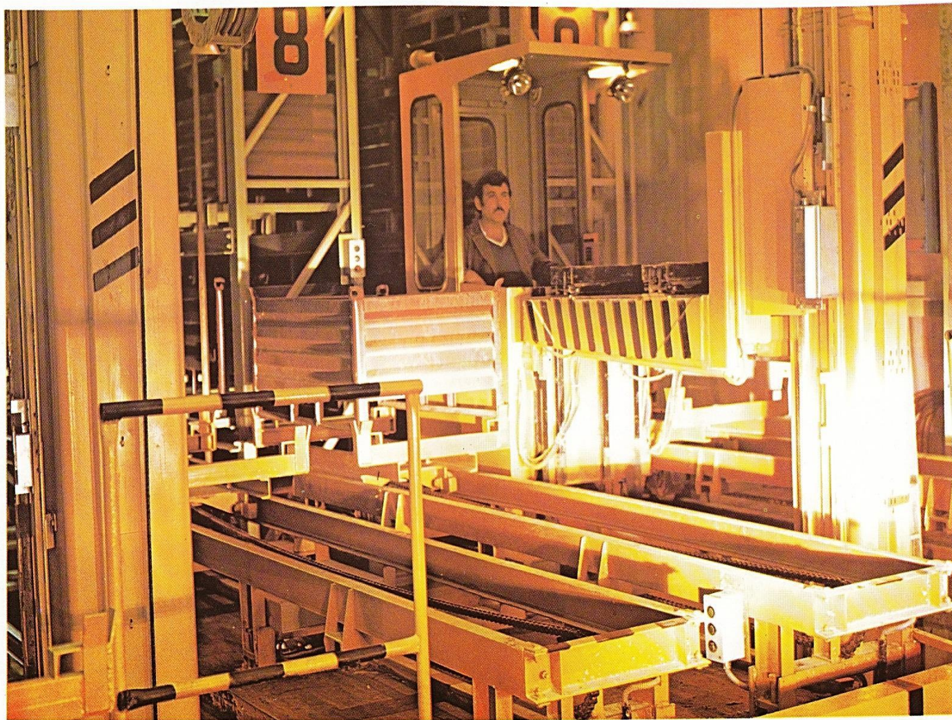
Полуавтоматизированная стеллажеобслуживающая машина в складе
